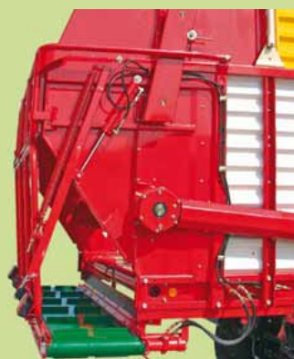
Cinta transportadora y fijación de la puerta trasera
